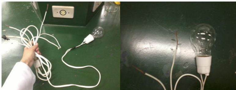
Figura 1. Condutímetro simples utilizado para este experimento.
